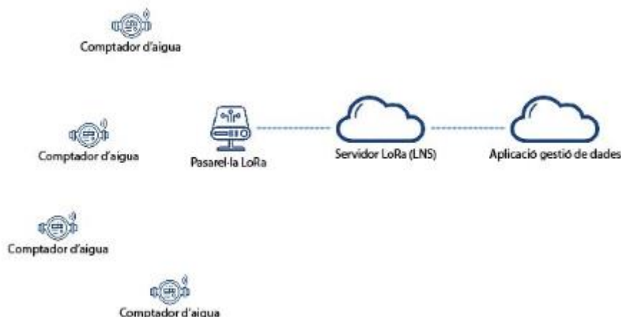
Imatge 8: Esquema de funcionament de la xarxa Lora
