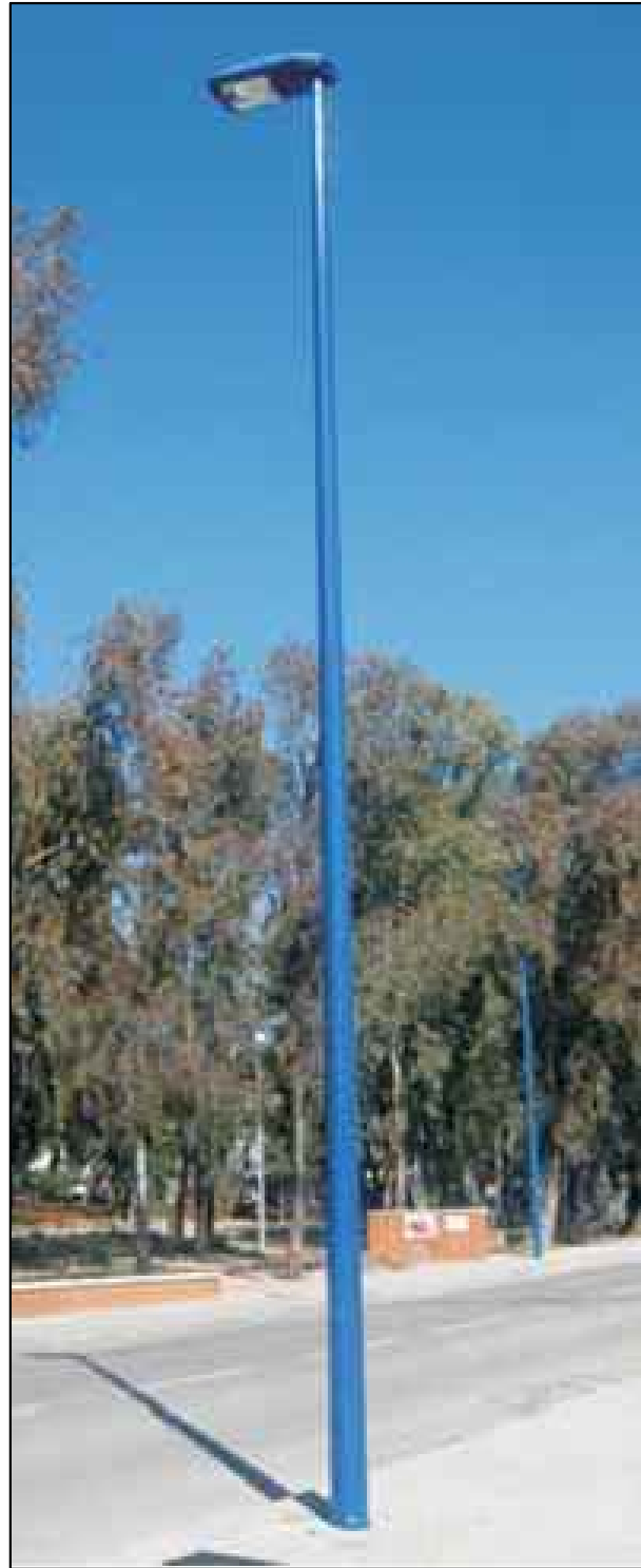
Columna troncocónica, conicitat: 12,5%, secció circular, material acer al carboni S 235 JR segons UNE EN 10025. Fabricació conforme a norma UNE EN 40-5. Alçada 6 m. Diàmetre Ø60mm. Base embutida. Porta enrasada. Perns i plantilla Incluits. (S'inclou una plantilla cada 6 columnes). Galvanitzat per immersió en calent segons UNE EN ISO 1461.
