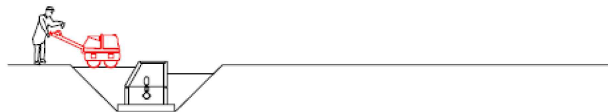
7. Compactació de terres al voltant del pou
