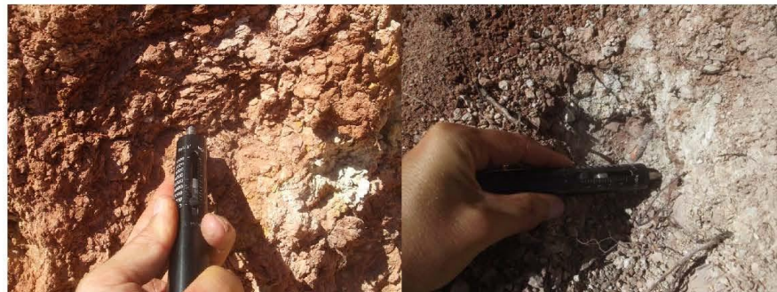
Figura 3.3.- Assajos in situ de la pressió màxima d'enfonsament als afloraments de les argiles i on s'observen valors > 4.0 kg/cm 2 (Fotos: 14/07/21)
