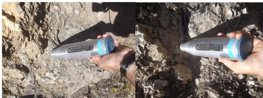
Figura 3.4.- Assajos in situ de la resistència a compressió simple als afloraments del massís rocós alterat i on s'observen lectures de 10 a 25 (Fotos: 14/07/21)
