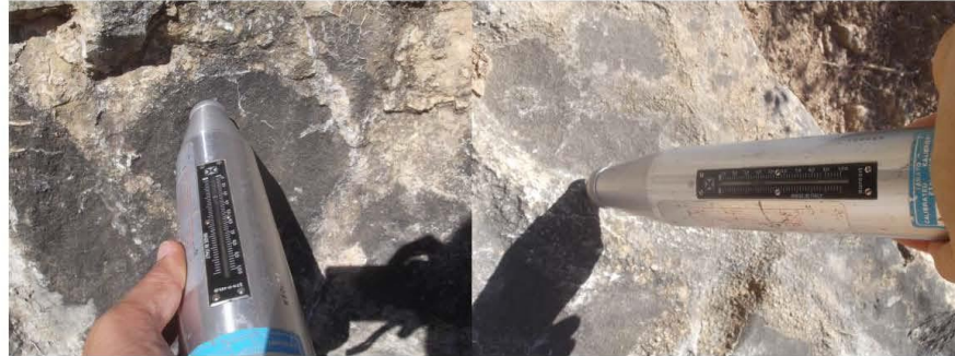
Figura 3.5.- Assajos in situ de la resistència a compressió simple als afloraments del massís rocós no alterat i on s'observen lectures de 30 a 38 (Fotos: 14/07/21)
